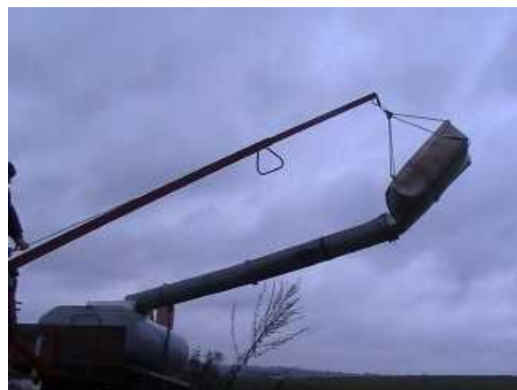
Hubstange am Traktor hebt Hubarm
