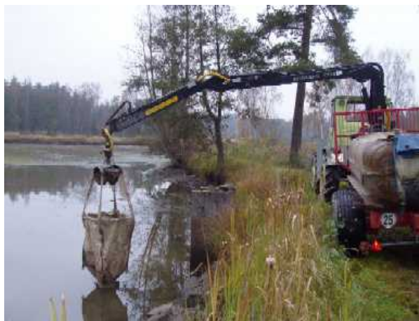
Forstrückewagen mit Transportbehälter
