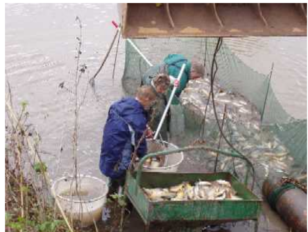
Fischkorb mit hydraulischer Entleerung
