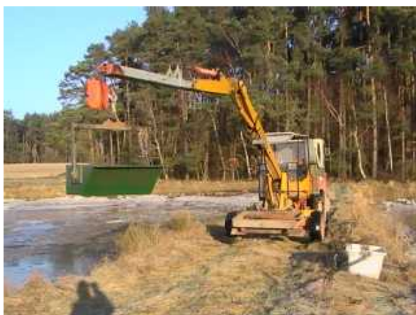
Heckbagger mit Kabine am Traktor
