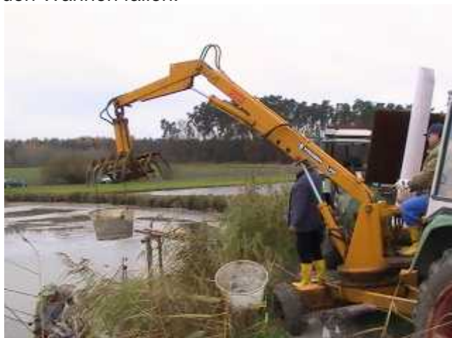
Heckbagger am Traktor
