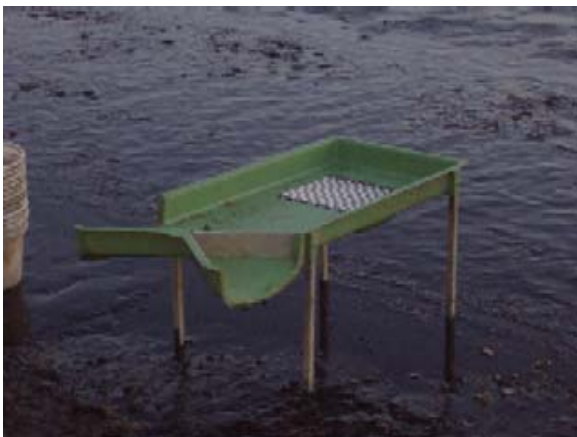
Sortiertisch mit Fischgitter
