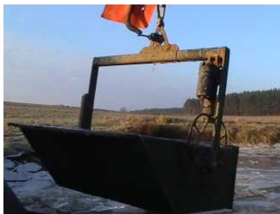
Fischkorb mit automatischer Entleerung
